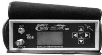
Medidor BirDog con batería interna, maletín protector y correa de cuello
